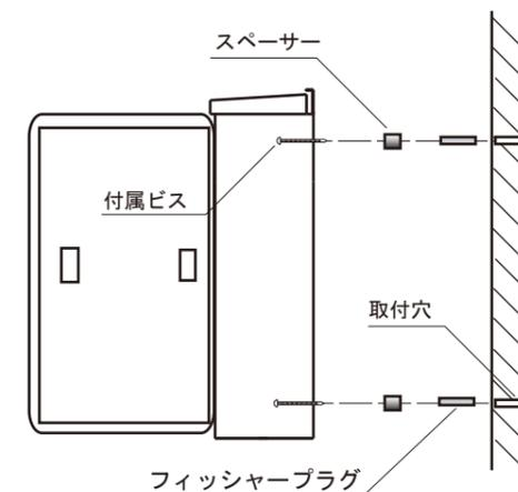
※取り付け前に、投函フタや各種可動部が瓦意匠タイルに接触しないことを確認してください。
